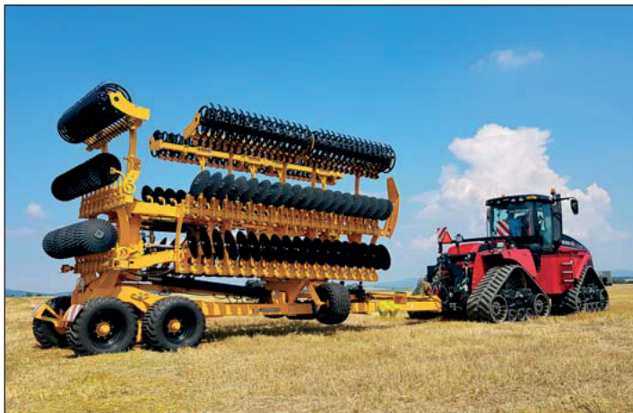
Napriek veľkému pracovnému záberu sa stroj zloží kompaktno do prepravnej šírky 3 m. Užívateľ určite ocení aj tandemovú transportnú nápravu, vďaka ktorej je ťažký podmietač (celkovo takmer 16 t) veľmi stabilný počas prepravy na ceste.
